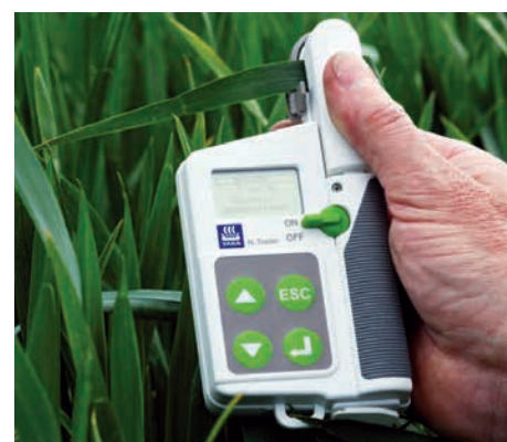
OBRÁZEK 16: Yara N-Tester je rukní nástroj, který poskytuje okamžitou informaci o aktuální potřebě dusíku.
