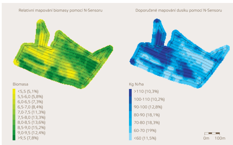
OBRÁZEK 14: Yara N-Sensor™ automaticky aplikuje optimální dávky dusíku (modrá), založené na mapování biomasy a chrolofylu (zelená) v reálném čase, čímž je zabráněno přílišnému či nedostatečnému hnojení. Ozimá pšenice, Německo. [ref. 5]
